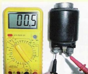
Si marcarse infinito significaría que hay una bobina cortada, si marca mucha resistencia significa que los hilos de la bobina o hacen mal contacto o el conductor está defectuoso.
