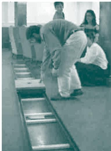
Instalación del travelling para la secuencia del baile. El carro está diseñado para permitir la fijación directa de la rótula del trípode y realizar tomas a ras de suelo.
